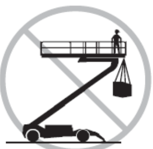
MÅ IKKE BRUKES SOM KRAN
