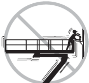
SKYV ELLER TREKK IKKE GJENSTANDER UTEN FOR PLATTFORMEN
